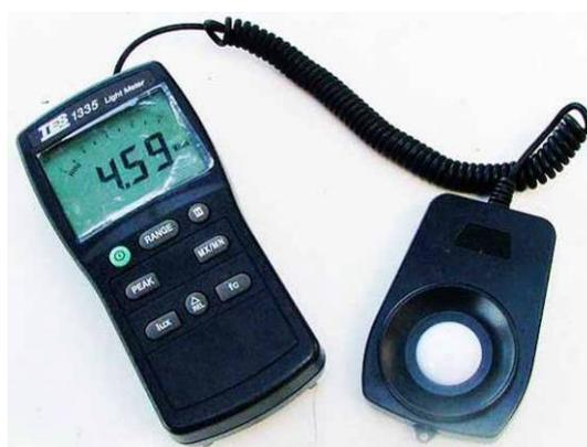
Fig. 62 – Luxímetro portátil utilizado nas medições de iluminância
