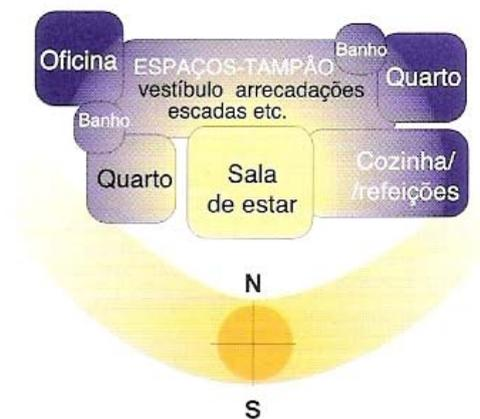
Fig. 14 – Desenho solar passivo, posicionamento dos espaços interiores para optimização do desempenho energético do edifício
