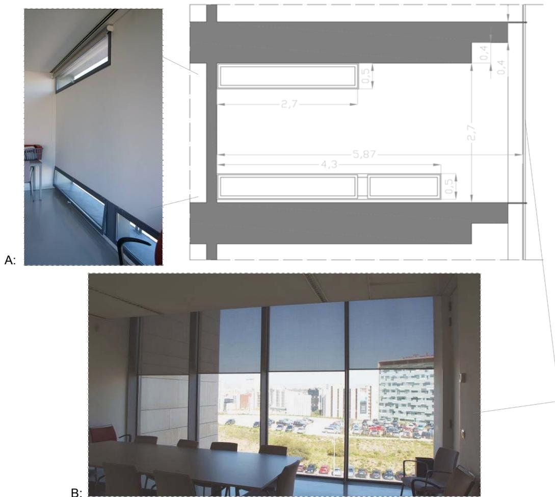
Fig. 71 – Corte esquemático da sala 2; A: Fotografia das aberturas laterais;
