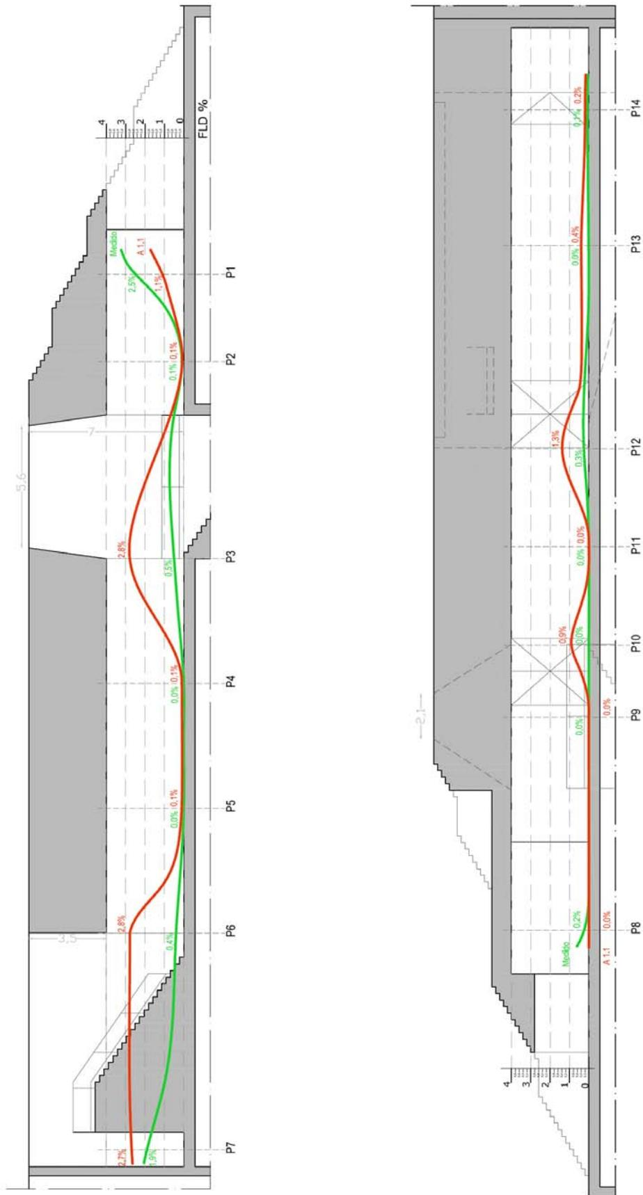
Fig. 99 – Gráfico da distribuição do FLD no átrio, sobre corte esquemático 1 e 2, respectivamente, considerando a alternativa 1.1
